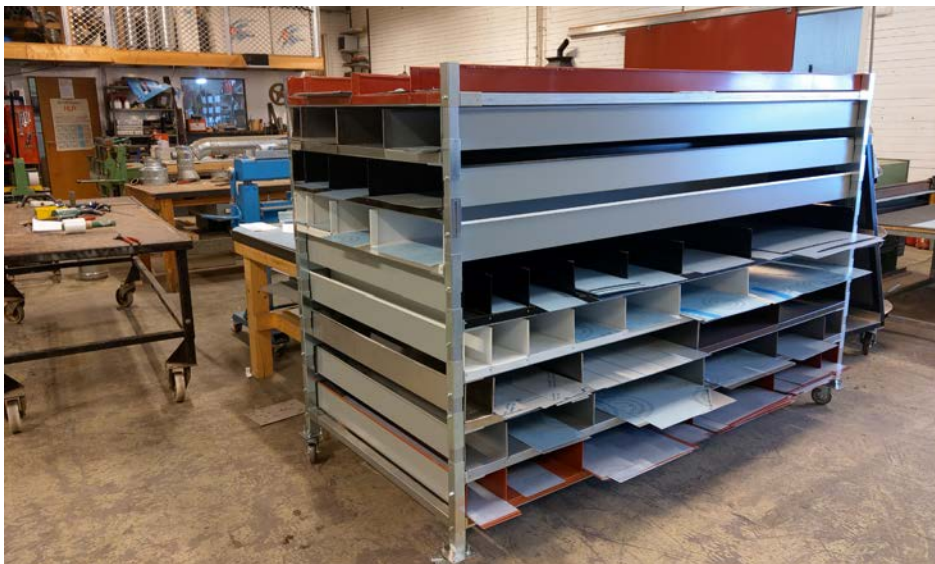
Sagen Blikk AS har testat denna konstruktion som en mellanstation för kapning. Metallskrot sorteras efter färg och typ och placeras bredvid skärmaskinen.
